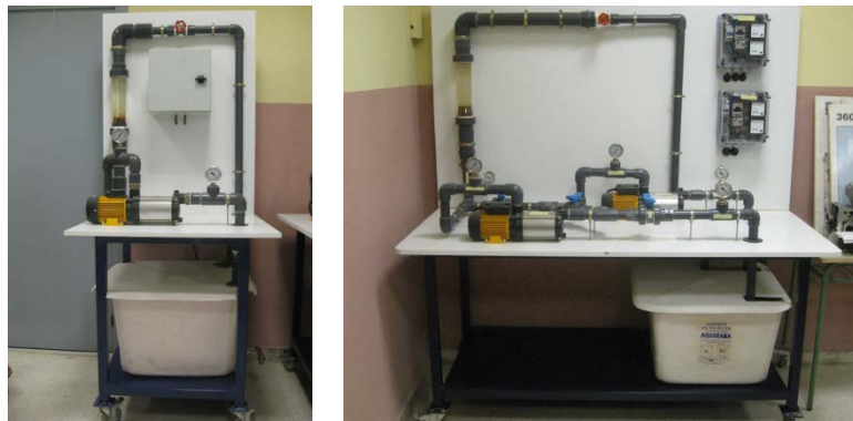
Figura 1. Bancos hidráulicos de ensayo de bombas diseñados y construidos por un estudiante durante la realización del Proyecto Fin de Carrera. (Izquierda) Banco que permite determinar curvas características de bombas para diferentes velocidades de giro; (derecha) banco para determinar curvas características de acoplamiento de bombas en serie y en paralelo.
