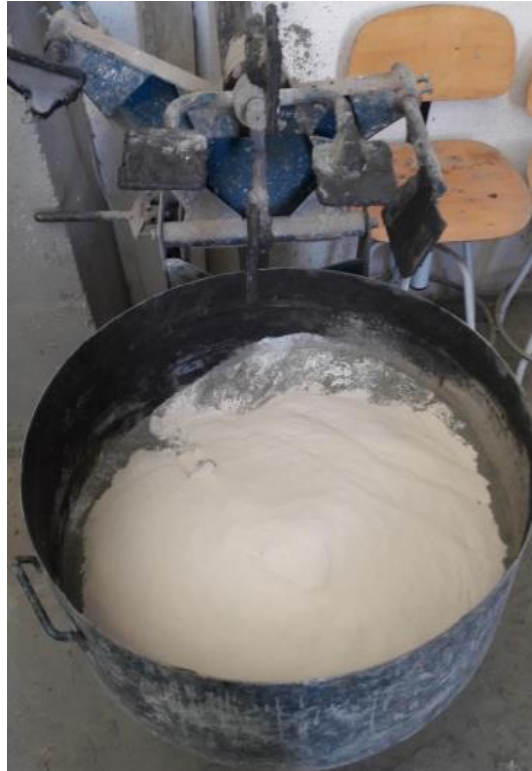
Fig. 3-4 Fotografía de la mezcla entre los materiales cementicios, áridos y cemento [29].
