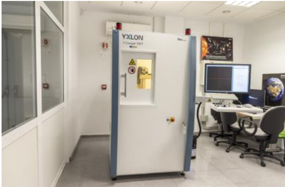
Fig. 4-2 YXLON Cougar equipo de tomografía computarizada de rayos X empleado en el C.I.T.I.U.S [38].
