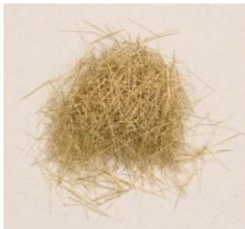
Fig. 3-3 Acero Dramix OL 13/20 utilizado como micro-fibras [40].
