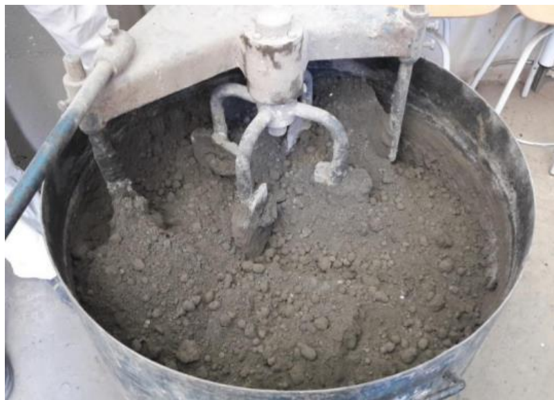
Fig. 3-5 Fotografía de la mezcla tras aportar las primeras cantidades de agua y superplastificante [29].
