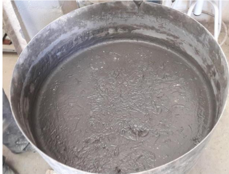
Fig. 3-6 Fotografía de la mezcla tras incorporar el volumen de fibras de DSL 2.5 [29].
