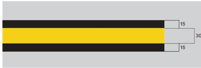
Figura 6-1. Señal de eje de calle de rodaje. *Fuente: OACI.*
