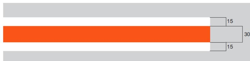
Figura 6-4. Señal de Borde de Área de Movimiento. Fuente: OACI.
