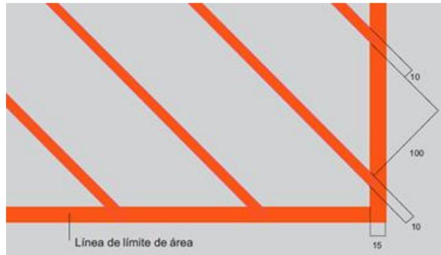
Figura 6-6. Señal de línea de Área de no estacionamiento. Fuente: OACI.
