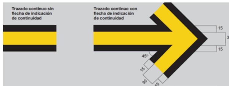
Figura 6-7. Señal de entrada de puesto de estacionamiento. Fuente: OACI.
