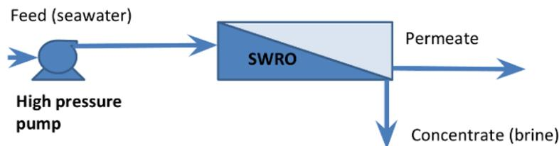
Figura 21. Diagrama conceptual del proceso básico de desalación de agua de mar [22].
