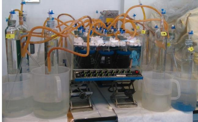
**Figura 9.** Sistema experimental para la determinación del Potencial Bioquímico de Metano (PBM).
