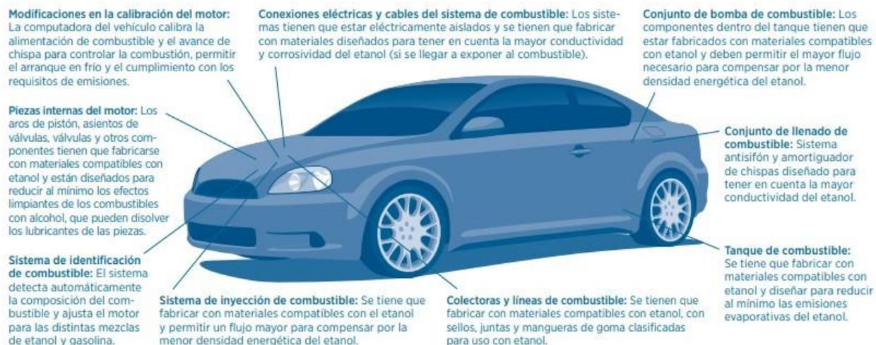
Ilustración 1: Adaptaciones necesarias para el uso de combustibles flexibles
