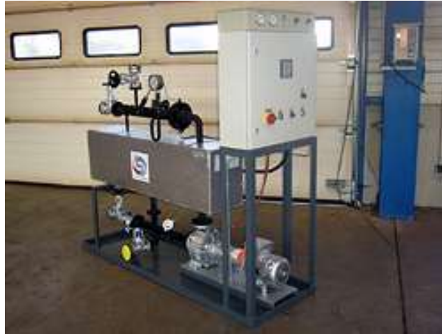
Figura 4-11 Caldera de aceite térmico BBS de 16 MW [Fuente: BBS]
