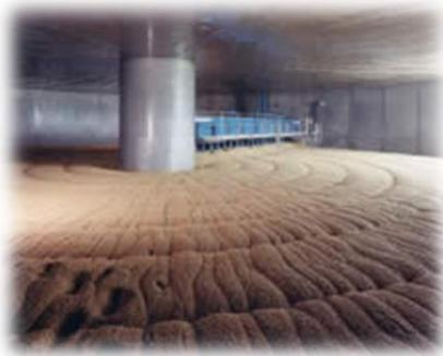
Ilustración 1.4 Depósito de germinación. (10)
