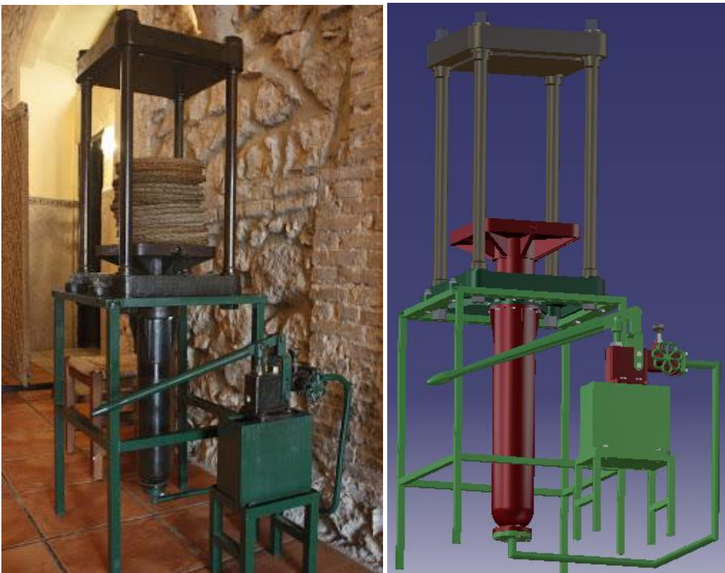
Figura 107 Prensa hidráulica de accionamiento manual del museo "El Molino Viejo" Fuente: Elaboración propia
