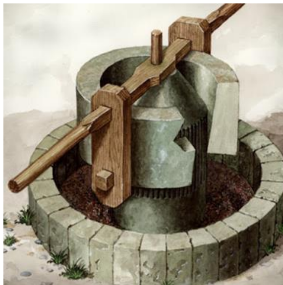
Figura 10 Ilustración de molino de piedras concéntricas acanaladas[18]
