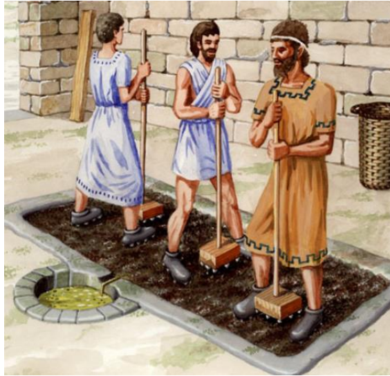
Figura 7 Ilustración del sistema conocido como Tudícula[18]
