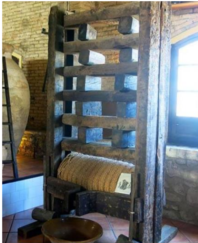
Figura 100 Prensa de cuñas grecorromana del museo "El Molino Viejo" Fuente: Aportación de Juan Cobo
