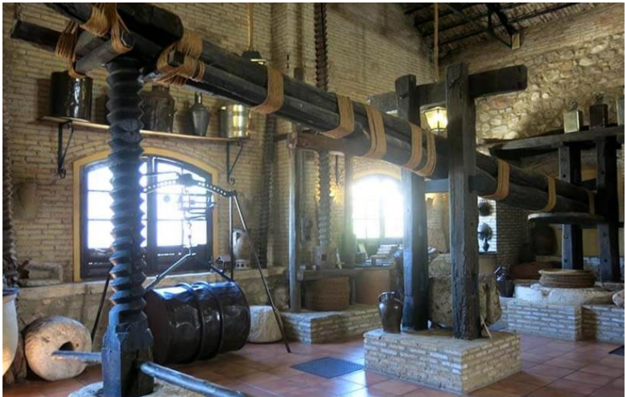
Figura 103 Prensa de viga y quintal del museo "El Molino Viejo" Fuente: Elaboración propia
