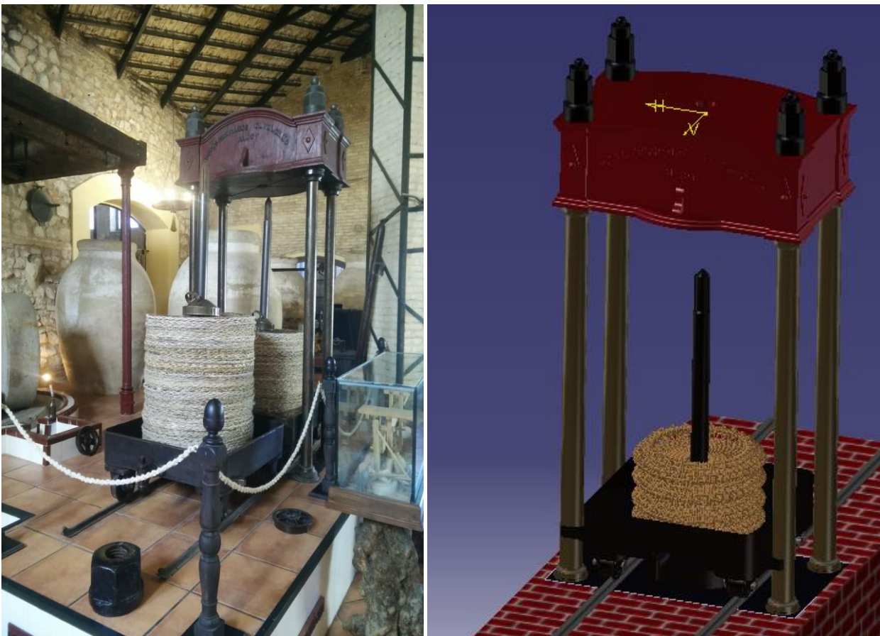
Figura 108 Prensa hidráulica de carriles del museo “El Molino Viejo” Fuente: Elaboración propia
