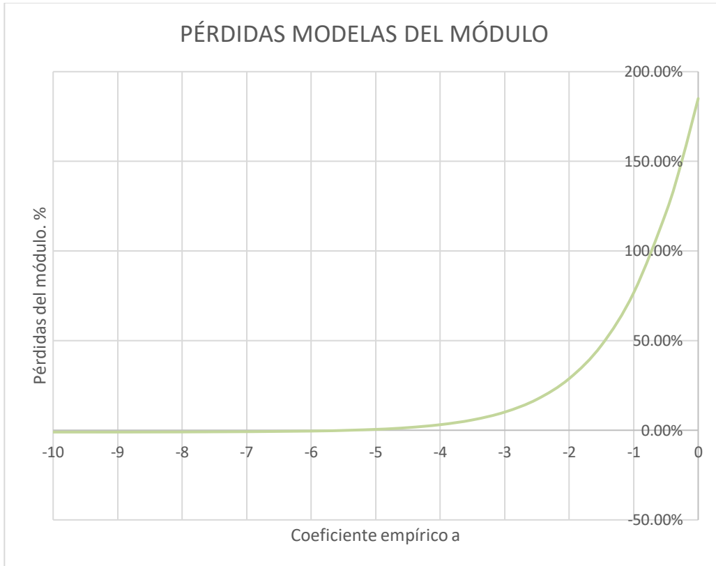
Figura 140. Pérdidas modeladas del módulo tras una variación del coeficiente empírico a en el sistema.
