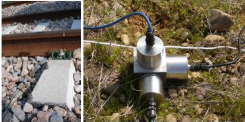
Figura 2-19 Acelerómetros adheridos a carril y traviesas (izquierda) y acelerómetro sísmico (derecha). Galvín, P., Domínguez, J.,2006, “Vibraciones ocasionadas en el suelo por paso de locomotora”
