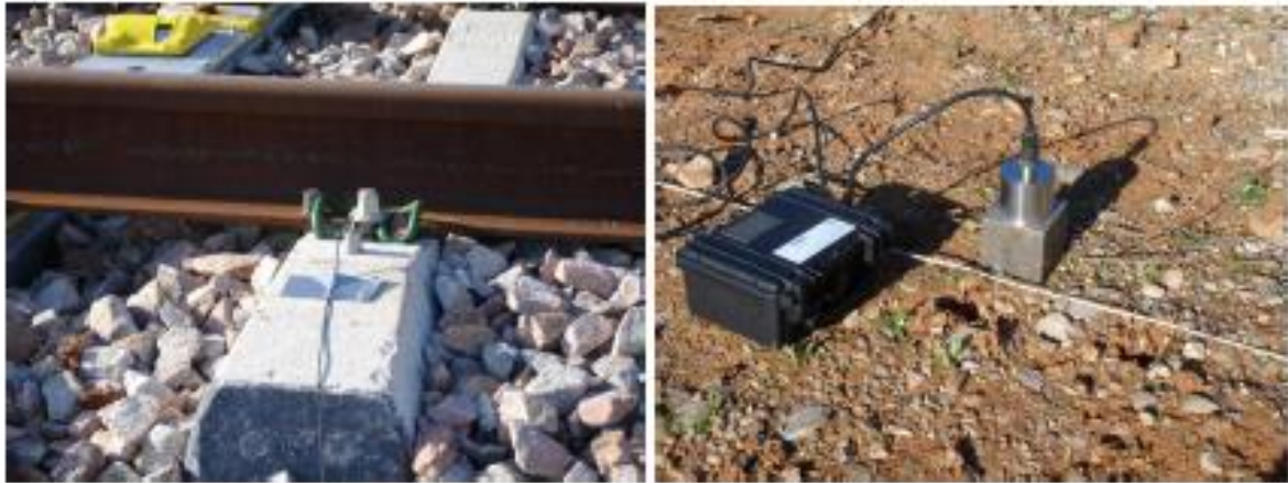
Figura 2-13 Acelerómetro adherido a carril y traviesas (izquierda) y acelerómetro sísmico (derecha). Galvín, P. 2007, “Análisis numérico y experimental de las vibraciones ocasionadas por el paso de trenes de alta velocidad en el suelo y en estructuras cercanas a la vía 3 ”
