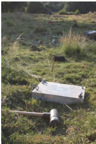
Figura 2-24 Equipo utilizado para producir las cargas impulsivas para la caracterización del terreno. “Estudio vibratorio. Línea de alta velocidad Madrid-Galicia”
