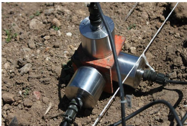
Figura 2-38 Estaca anclada en el suelo con acelerómetros dispuestos para medir las direcciones longitudinal, transversal y vertical. “Estudio vibratorio. Línea de alta velocidad Madrid-Galicia”
