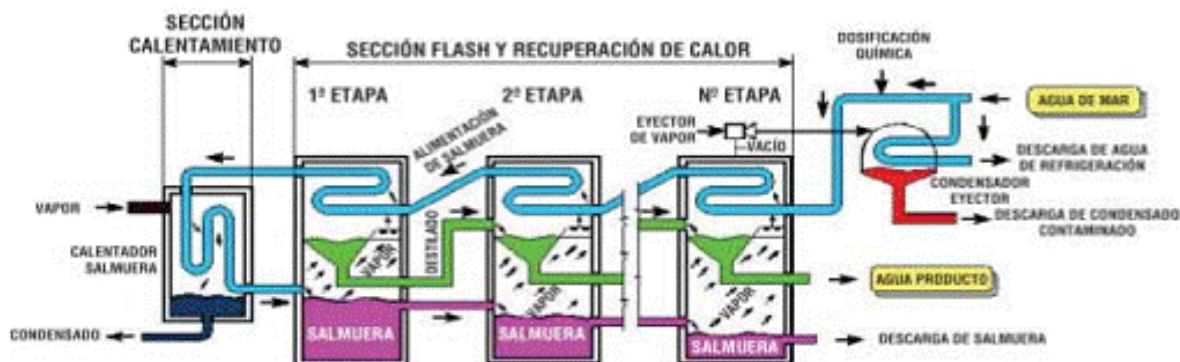
Figura 3 Proceso de evaporación súbita flash, (Roa, 2014)
