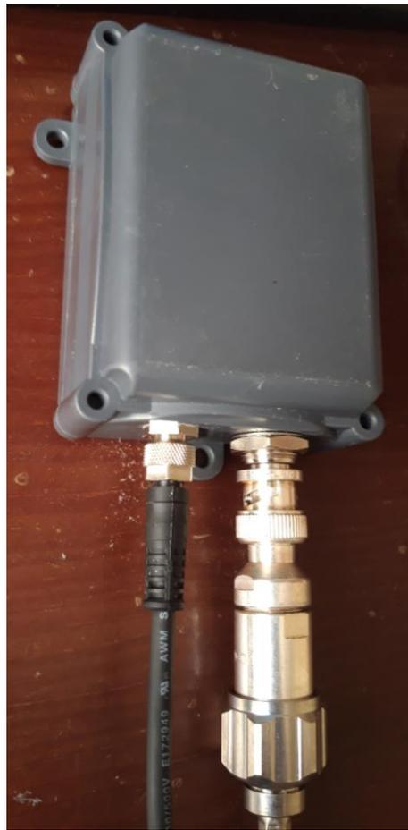
**Figura 42.** Prototipo terminado con conector de alimentación (izquierda) y antena (derecha).
