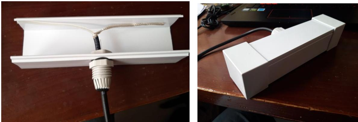
**Figura 58.** Dipolo en cobertura, y cobertura completa.
