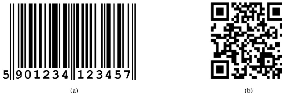
**Figura 101.** Estructuras de códigos de barras: (a) unidimensional con codificación EAN 13 y (b) bidimensional (QR)
