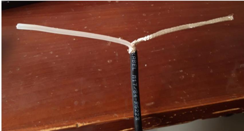
Figura 55. Dipolo con cable coaxial, de 16 cm de un extremo a otro.
