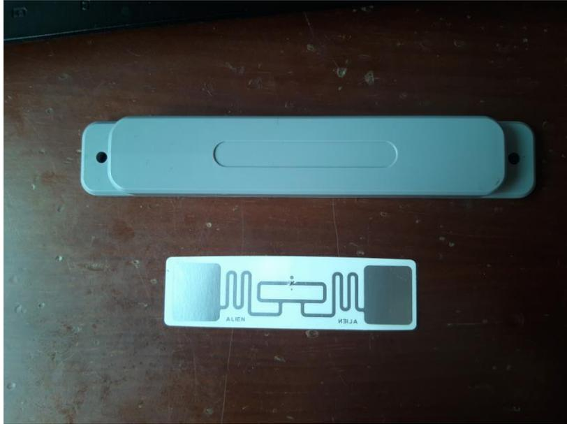
**Figura 10.** Etiquetas pasivas. Arriba la HYT-MT-U031b, abajo la ALN-9662.
