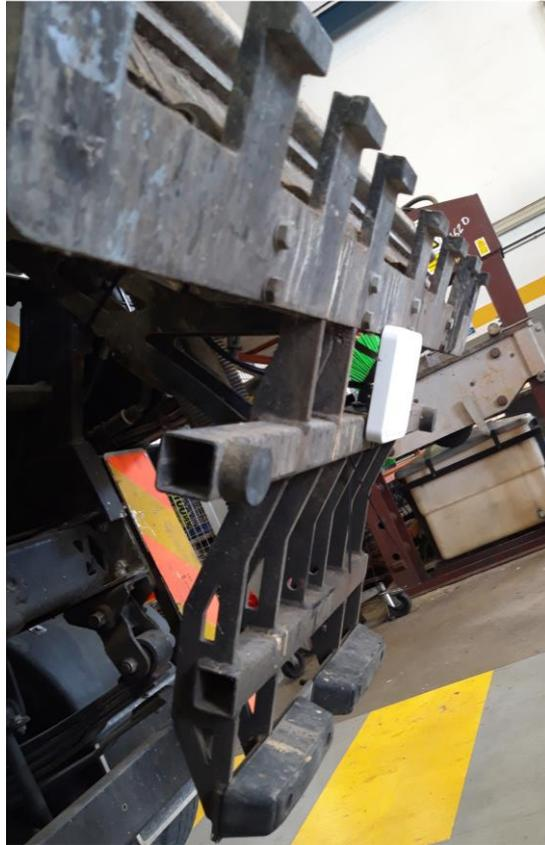
**Figura 53.** Vista lateral de estructura recogedora de cubos, con antena HYN503 en parte media.
