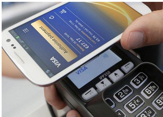
**Figura 102.** Sistema de pago mediante NFC.
