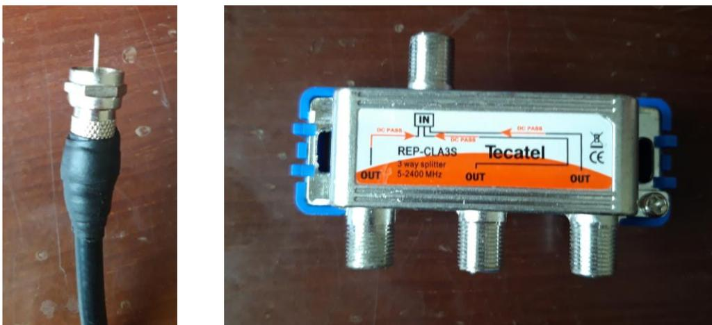
**Figura 59.** Conector tipo F y splitter de 3 entradas.
