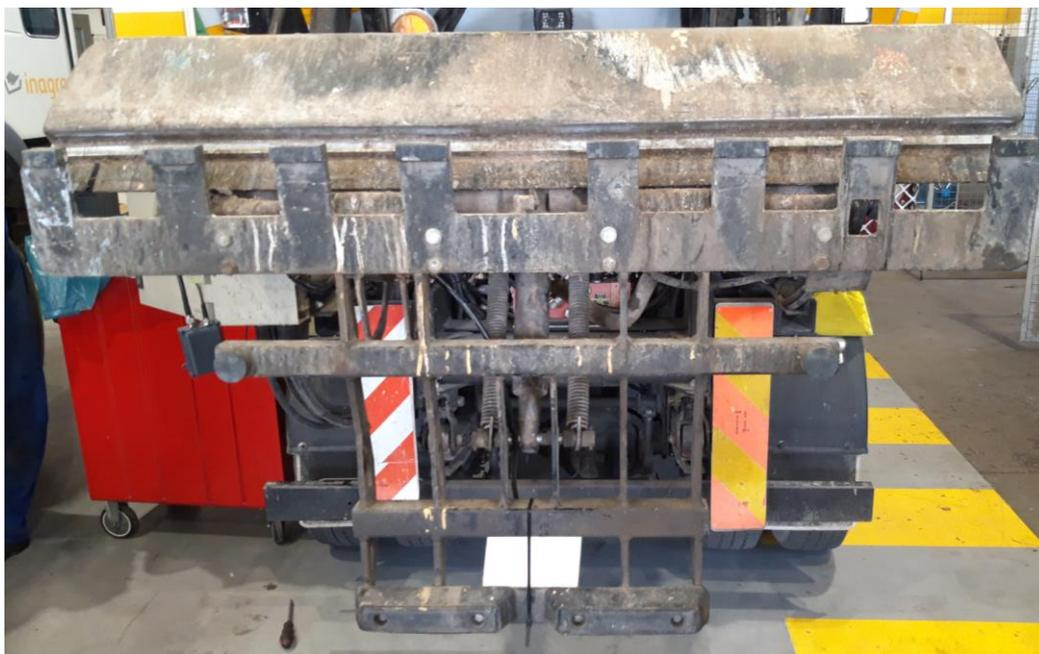
**Figura 52.** Vista frontal de estructura recogedora de cubos, con antena HYN503 en la parte inferior.
