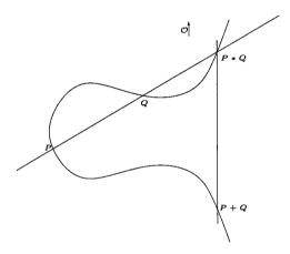
El opuesto de un punto Q=(x,y) será -Q=(x,-y) (su simétrico respecto del eje OX), ya que  $Q*(-Q)=\mathcal{O}$ , y como la recta que une  $\mathcal{O}$  con  $\mathcal{O}$  es la del infinito, el tercer punto de corte con E será también  $\mathcal{O}$ , luego  $Q+(-Q)=\mathcal{O}$ .
