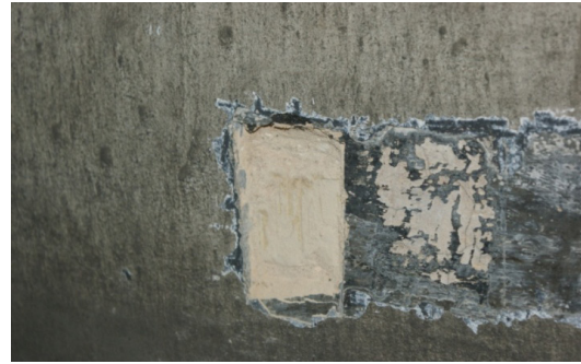
Figuras 4. Extracción de muestra mediante corte y levantamiento del revestimiento completo.
