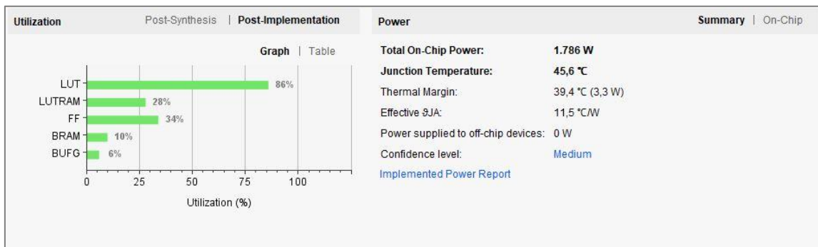
Figura 63. Utilización de la FPGA tras la implementación del sistema empotrado que utiliza DMA.
