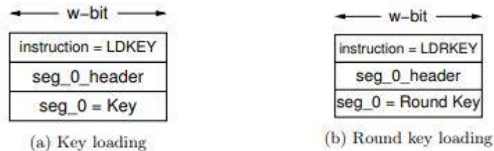
Figura 10. Formato de sdi para a) Cargar clave principal, b) Cargar secuencia de rondas de clave.
