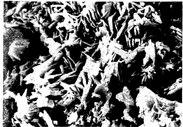
Fig. 10.—Microfotografía de material de Espera alterado (x4.000).
