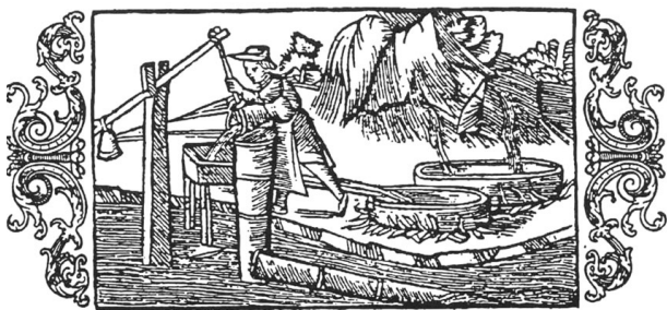
Figura 16: Grabado del siglo XVI. Mediante un cigüeñal y unos pequeños canales de madera se vierte el agua marina directamente a las grandes cazuelas de cocción (según Gouletquer y Daire, 1994: fig. 47)
