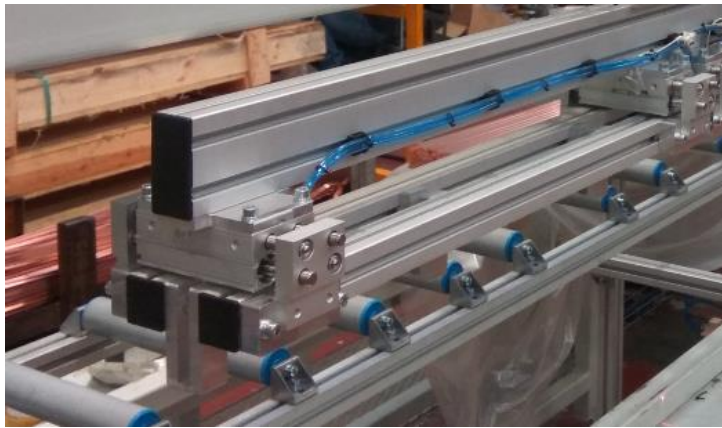
Fig. 3.46 Pinzas con dedos en la máquina acabada
