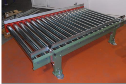
Fig. 2.3 Transportador de rodillos de gravedad
