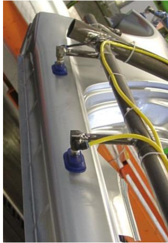
Fig. 2.4 Ventosas manipulando pieza de la industria de la automoción.
