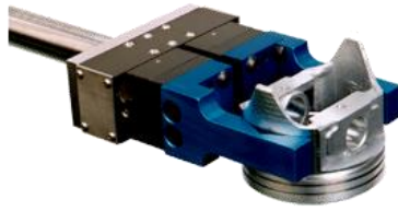
Fig. 2.5 Imagen de una pinza neumática que manipula pistones
