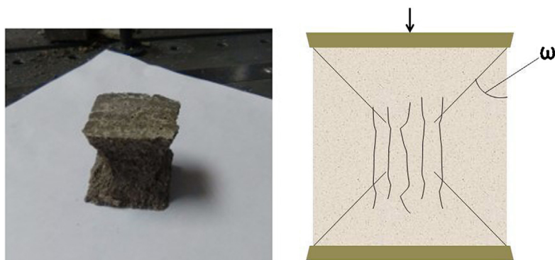
Figura 6 – Rotura típica de morteros de cemento.
