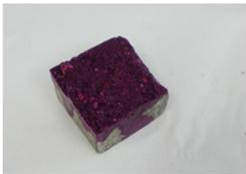
Figura 8 – Ensayo del test de fenolftaleína.
