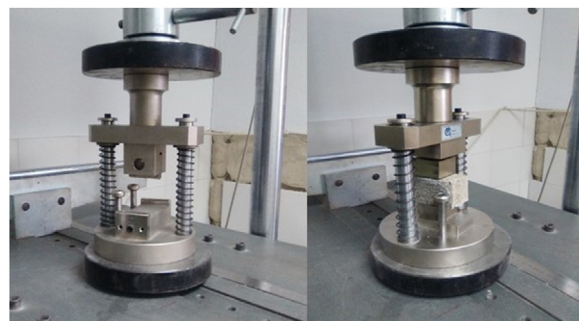
Figura 5 – Dispositivos de ensayo a flexión (izquierda) y compresión (derecha).
