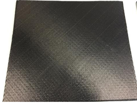
Figura 51: Apilado del laminado rígido del panel de tejido.
