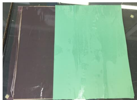
Figura 56: Colocación del adhesivo y el teflón para el co-encolado.
