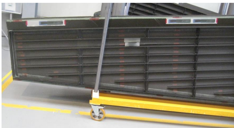
Figura 2: Elemento aeronáutico con laminado similar a los de los larguerillos encolado a la piel en la zona de recanteo [Combinación 3].
