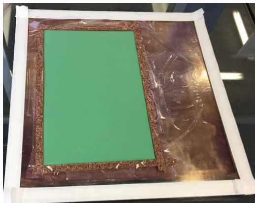
Figura 48: Preparación de la bolsa de vacío para el panel de adhesivo.
