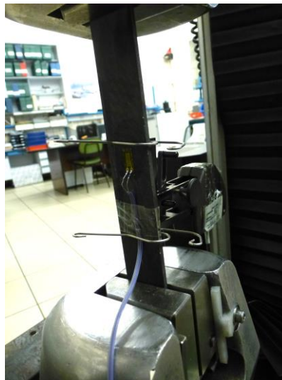
Figura 59: Ensayo de tracción a la muestra de tejido.
