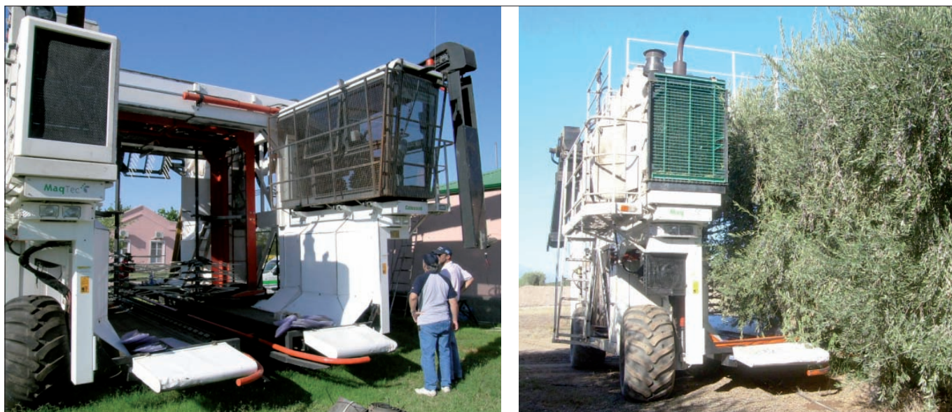
Foto 17. Cosechadora 'cabalgante' (Colossus) para variedades de aceite. Puede cosechar árboles de hasta 4 m en altura y 4 m en diámetro.
