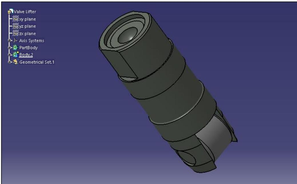
Figura 109. Imagen del diseño en CATIA del elevador de válvula hidráulico.
