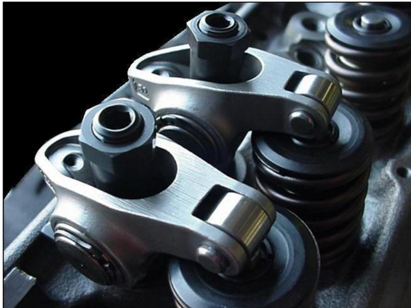
**Figura 53.** Disposición de los balancines sobre culata de un motor. (Fuente: Bolig, Randy. 2016. *Can you gain horsepower by changing rocker arms?* <[www.chevyhardcore.com](http://www.chevyhardcore.com)>.)
