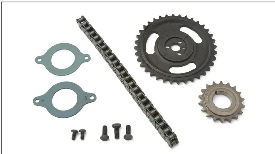
Figura 110. Kit de cadena de distribución a rodillo individual con P/N 12371043. (Fuente: Chevrolet.)
