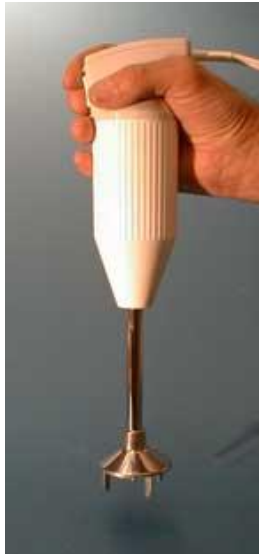
Figura 2.1: Sistema de generación masiva de burbujas: Mezclador.
