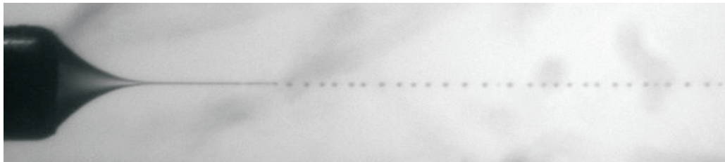
Figura 2.5: Configuración de coflujo operando en el régimen de narrowing.
