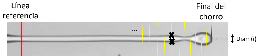
Figura 3.12: Imagen que muestra el proceso seguido para el cálculo del diámetro del chorro. Se almacena la distancia entre los puntos de corte (cruces) de las líneas verticales (amarillas) con la frontera del chorro.
