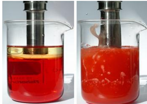
Figura 2.2: Sistema de generación masiva de burbujas: Emulsificador de ultrasonido.
