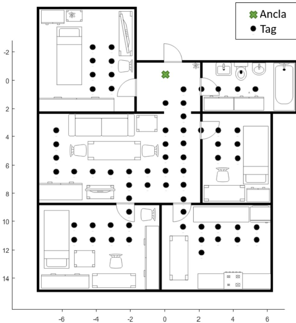
Figura 6-1. Plano de casa y posiciones de Ancla y Tag. Ejes medidos en nº de losetas.
