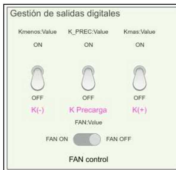
Ilustración 46.- Detalle del HMI para gestión de las salidas digitales de la aplicación.
