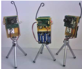
Figura 4: Detalle de los nodos de la red de cámaras WSN. Cada nodo está integrado por un módulo CMUcam3 conectado a un nodo WSN.
