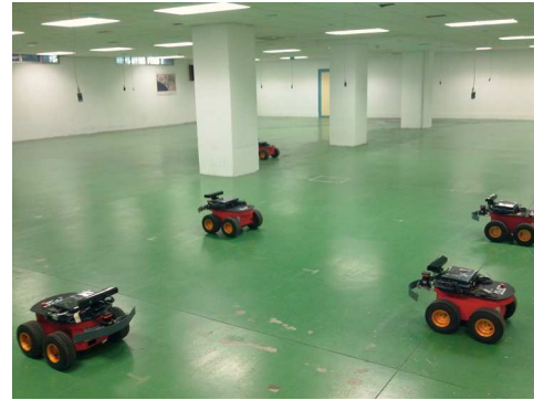
Figura 2: Fotografía del banco de pruebas instalado en una sala de 500 m 2 en los sótanos del edificio principal de la Escuela Técnica Superior de Ingeniería de la Universidad de Sevilla. Pueden observarse 5 robots Pioneer 3-AT y los nodos de la red WSN colgando del techo.
