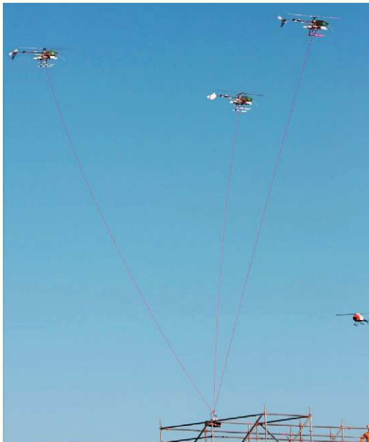
Figura 10: Transporte cooperativo de una carga mediante 3 UAVs.
