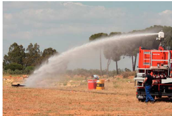
Figura 9: Sistema automatizado de extinción empleado en las misiones de confirmación, monitorización y extinción de incendios.
