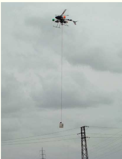
Figura 3: Transporte de carga mediante un helicóptero autónomo.
