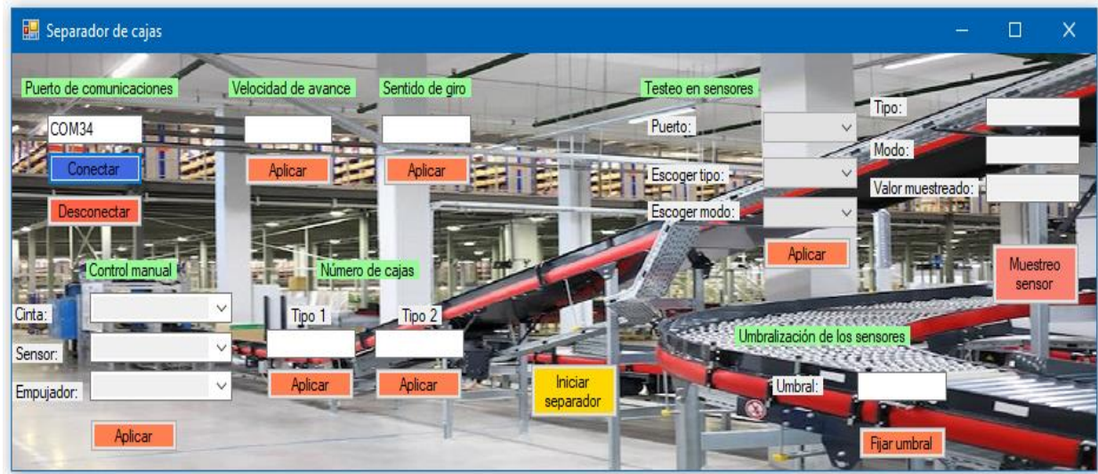
Figura 36. Interfaz hombre-máquina del separador
