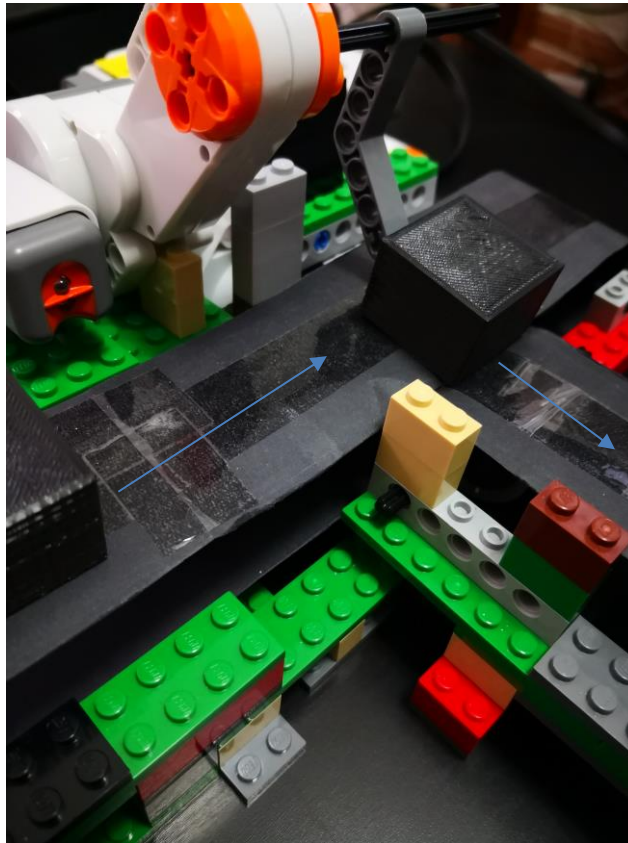
Figura 33. Diseño final del separador, detalle del empujador.
