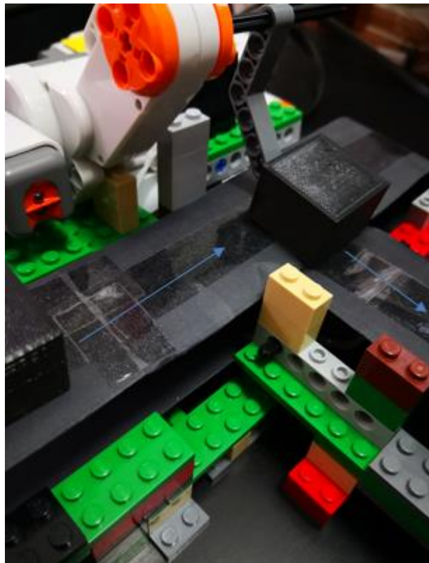
Figura 47 Detalle de funcionamiento para el empujador de material.
