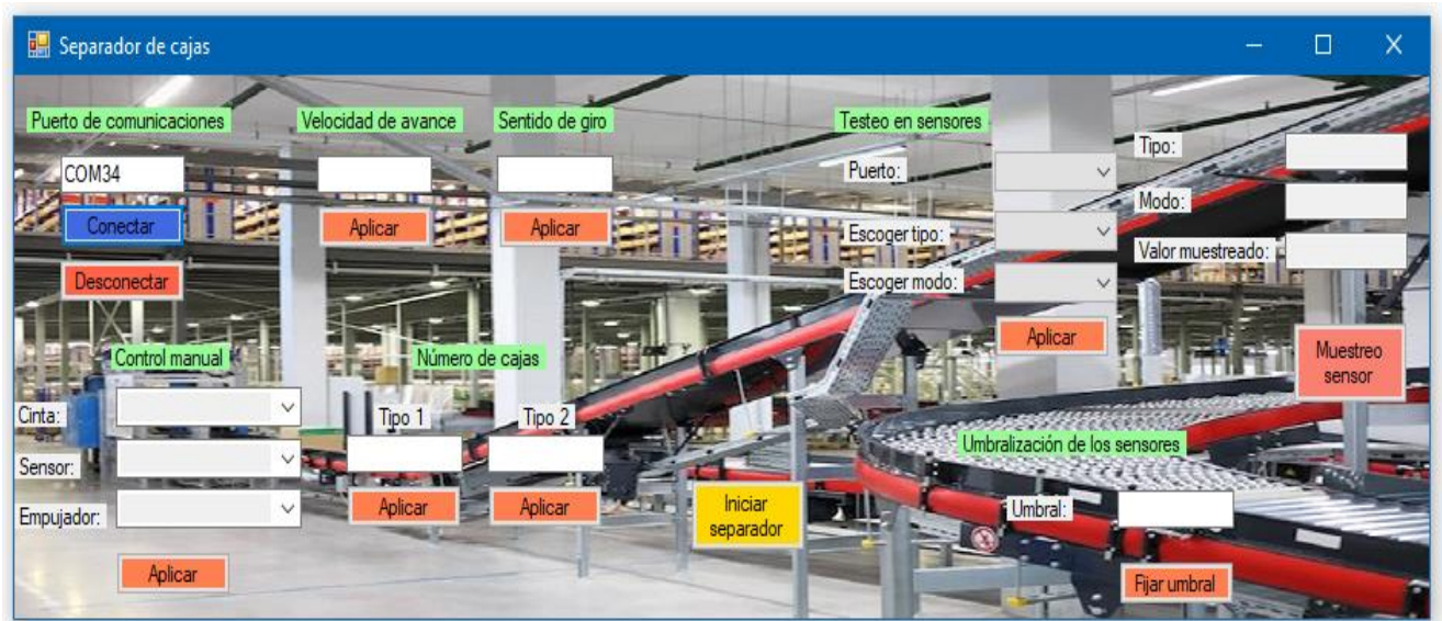
Figura 43 Interfaz HMI para el separador de cajas automático.
