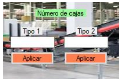
Figura 37 Interfaz HMI para el separador de caja. Botonera dedicada a la secuencia de fabricación.
