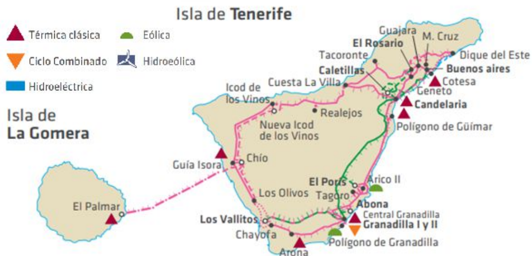
Red de Transporte Eléctrica y Centrales Principales – Islas de Tenerife y La Gomera – Año 2016. Fuente: Red Eléctrica de España
