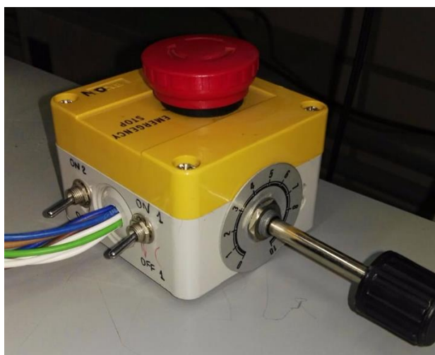
Figura 18. Seta de control y potenciómetro para control del ángulo de disparo del puente de tiristores.
