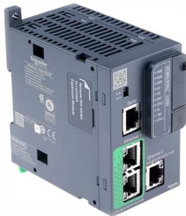
Figura 20. Aspecto físico del dispositivo PLC de SCHENIDER, modelo TM251MESE.
