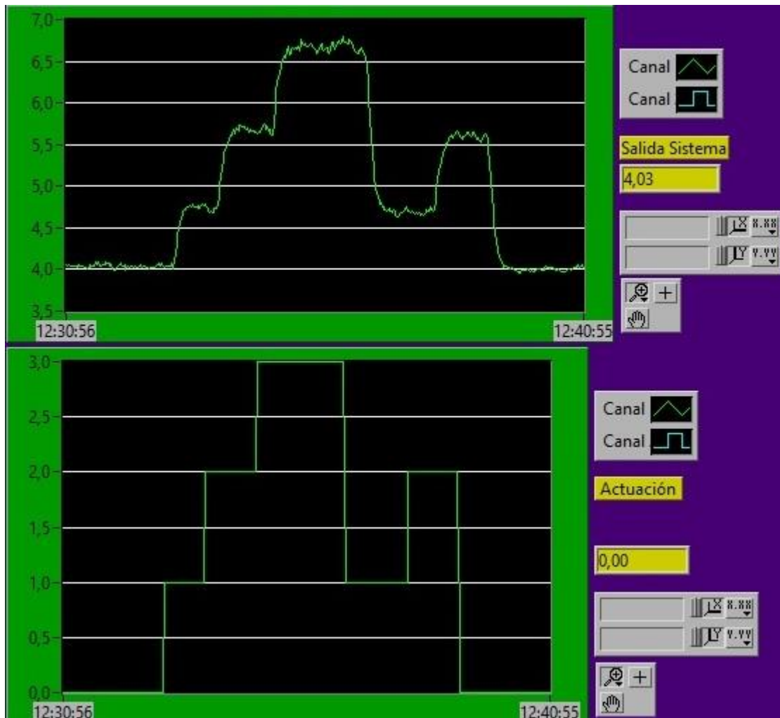
Figura 5-12. Prueba del sistema en modo automático.
