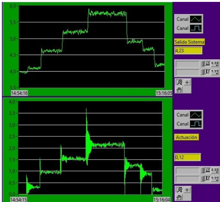
Figura 5-14. Prueba del sistema modificando parámetros de sintonización.
