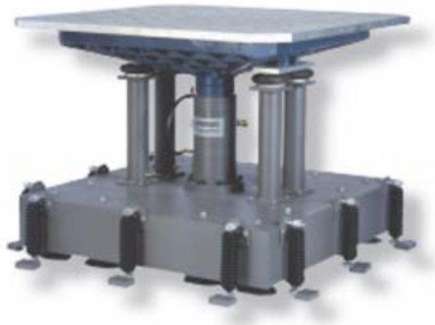
Figura 4-1. Shaker hidráulico (Fuente: Halt&Hass Consulting)
