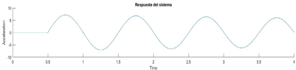
Figura 3-5. Respuesta de aceleraciones ( \text{m/s}^2 ) en el dominio del tiempo (s) para f=1\text{Hz} y \zeta=0.01
