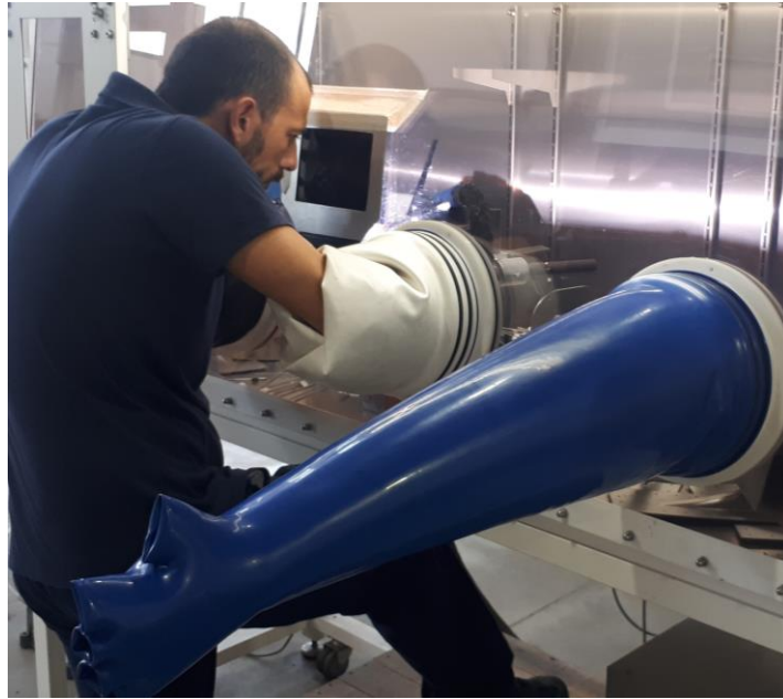
Figura 6.3. Operario realizando el soldeo en cámara inerte
