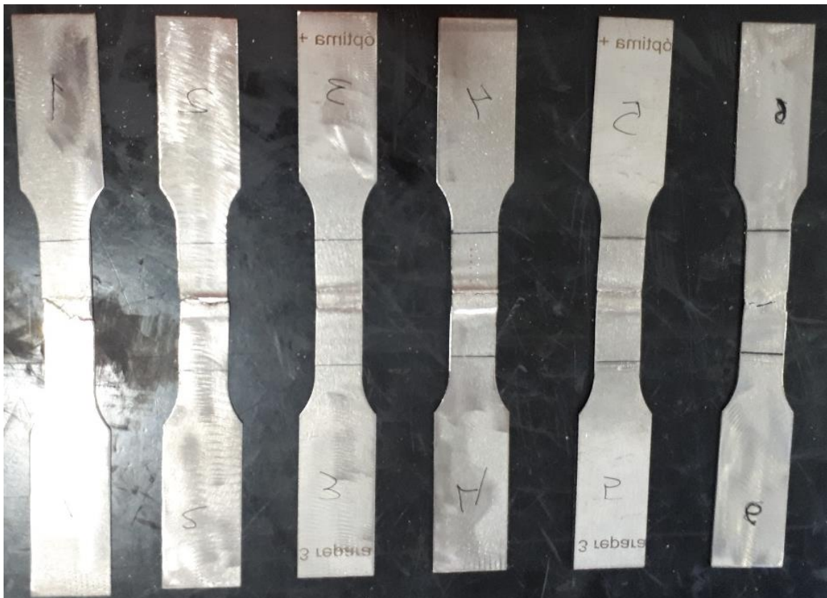
Soldadura óptima + 3 reparaciones completas (espesor = 1 mm)
