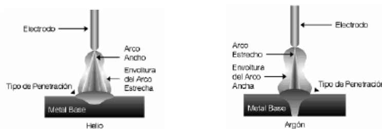
Figura 2-6. Aspecto de la penetración usando helio (izquierda) y argón (derecha) [6]
