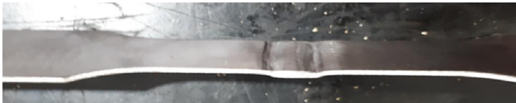
Figura 7-3. Deformaciones ocasionadas por la soldadura en una probeta sometida a 2 reparaciones
