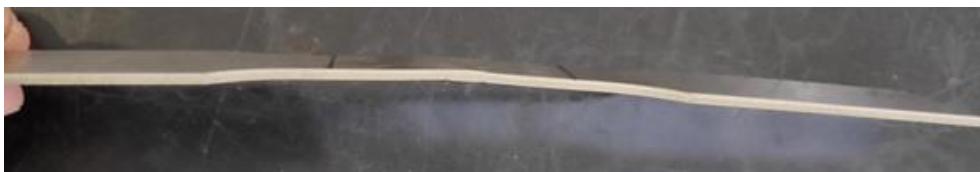
Figura 7-7. Geometría de una probeta sometida a 5 reparaciones
