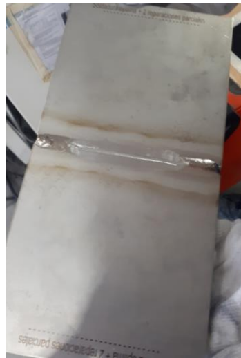
Figuras 6.4 A y B. Eliminación del cordón de soldadura para simular la reparación
