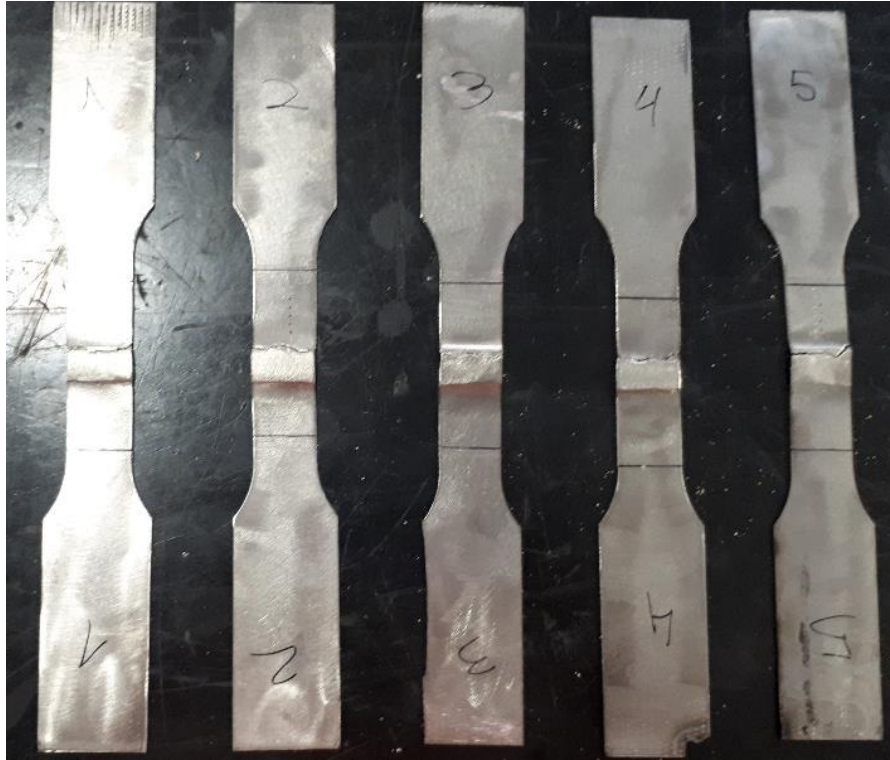
Soldadura óptima + 5 reparaciones completas (espesor = 1 mm)
