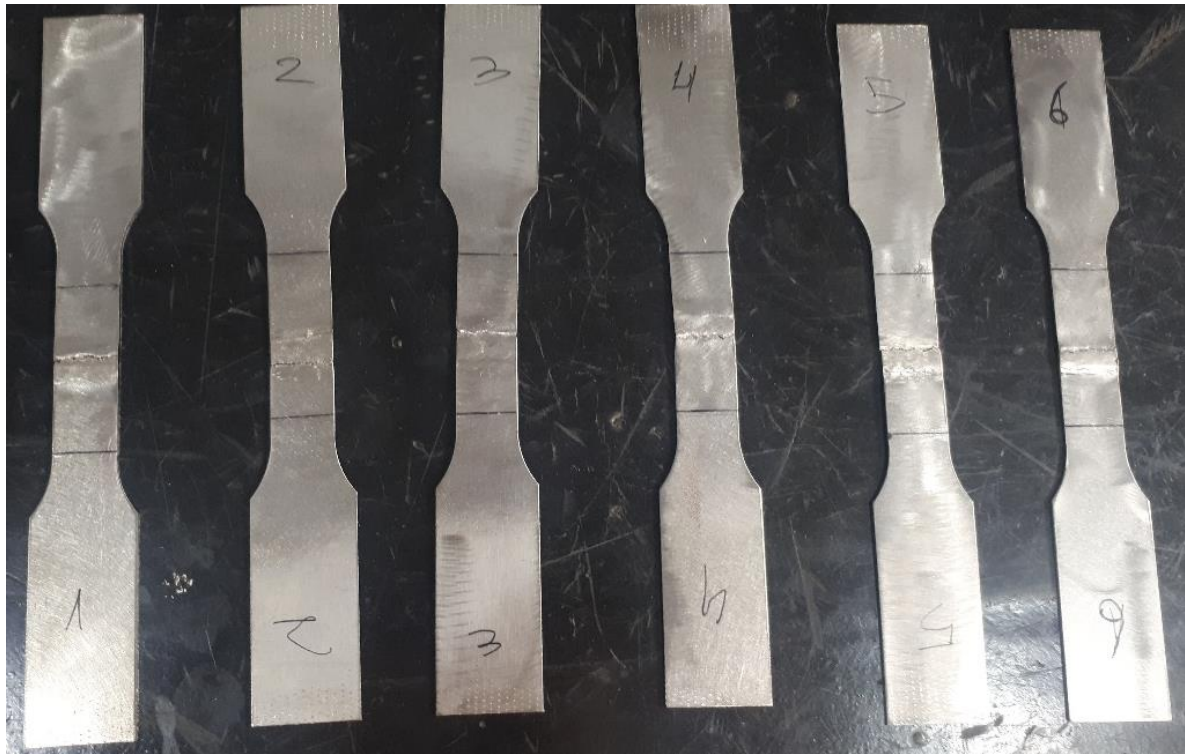
Soldadura óptima + 3 reparaciones completas (espesor = 1 mm)
