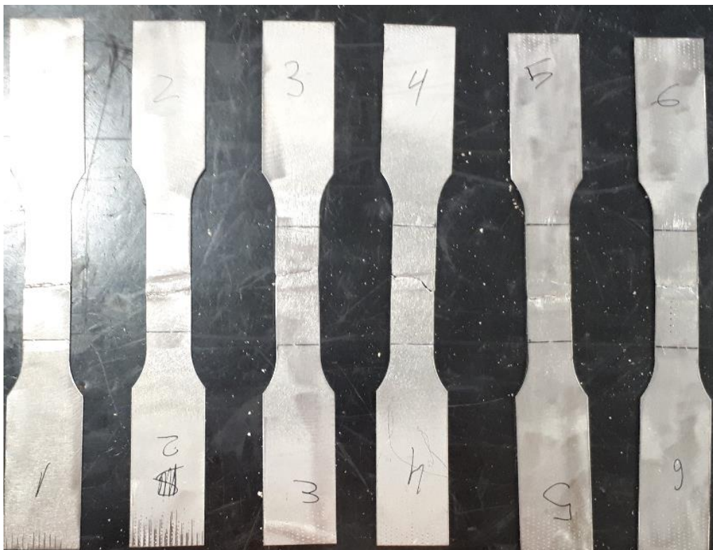
Soldadura óptima + 3 reparaciones completas (espesor = 2 mm)
