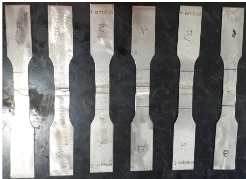
Soldadura óptima + 1 reparación completa (espesor = 1 mm)
