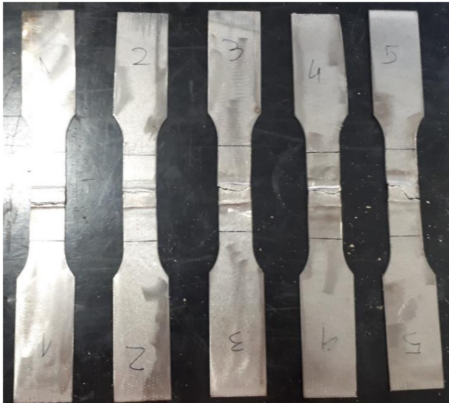
Soldadura óptima + 5 reparaciones completas (espesor = 1 mm)
