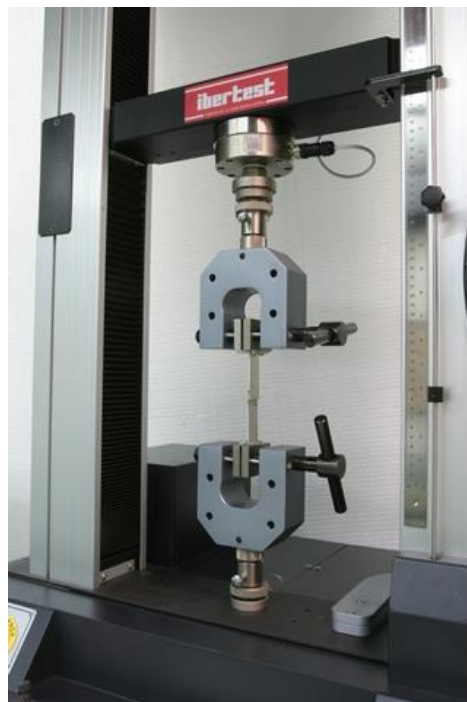
Figura 5-1. Máquina de ensayo de tracción real [19]
