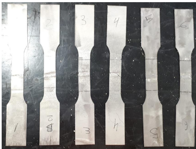
Soldadura óptima + 1 reparación completa (espesor = 1 mm)
