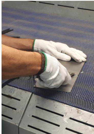
Figuras 6.4 A y B. Eliminación del cordón de soldadura para simular la reparación
