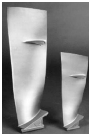
Figura 3.6. Grandes aspas de ventiladores (la más grande de más de un metro) fabricadas de Ti-6Al-4V forjado [26]
