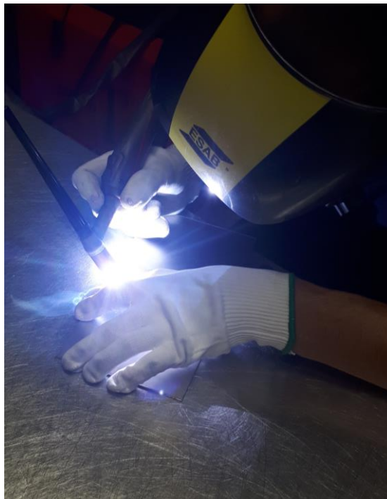
Figura 6.2. Proceso de punteo sin usar material de aporte
