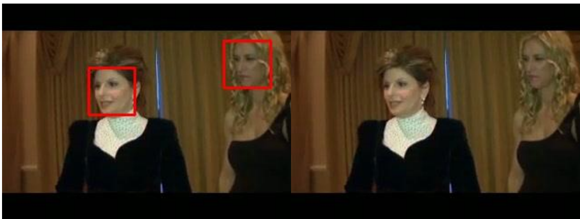
Ilustración 58. Resultados obtenidos con MTCNN y DLIB respectivamente usando una imagen del dataset YouTube Faces Database.
