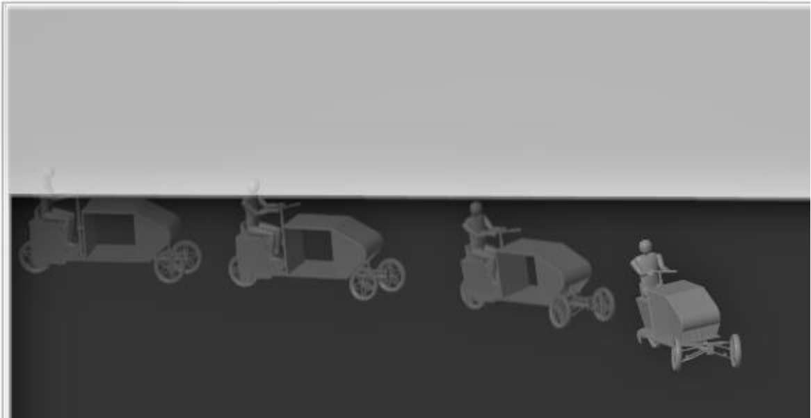
Figura 88. Proceso de inclinación del vehículo durante la simulación.
