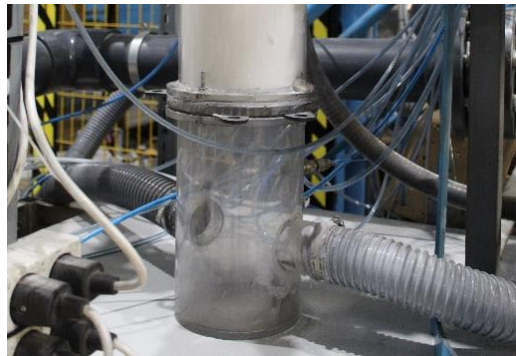
Figura 3-2. Plenum situado en la parte inferior del riser .
