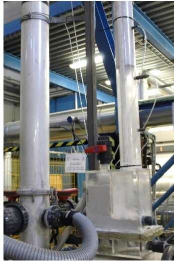
Figura 3-20. Formación de slugs entre el downcomer y la cámara de suministro.
