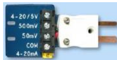
Figura 3-16. Ficha monocanal para la transferencia de datos al ordenador.
