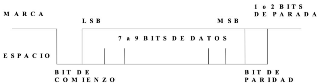
Figura 7: Trama de comunicación RS-232.
