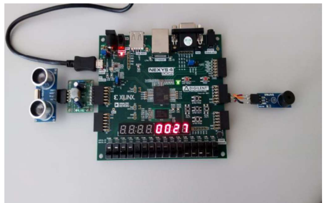
Fig. 7 Placa de desarrollo, medidor y zumbador. Resultado tras Práctica 4.
