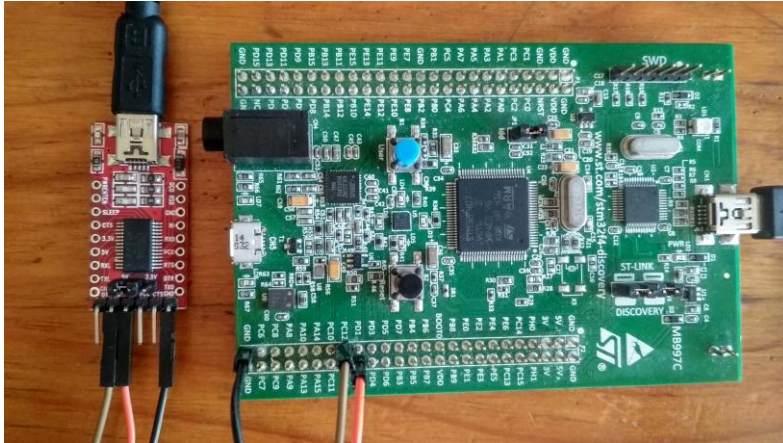
Figura 3-6: Conexionado entre la placa de desarrollo y el convertor FTDI232.
