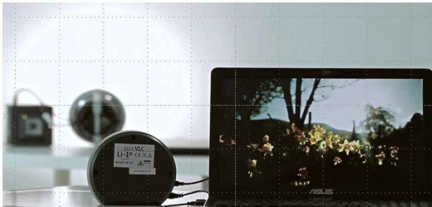
Figura 2-3: Transmisión de un vídeo mediante Li-Fi en el caso de no tener línea de visión directa (NLOS). (Fuente: [19])
