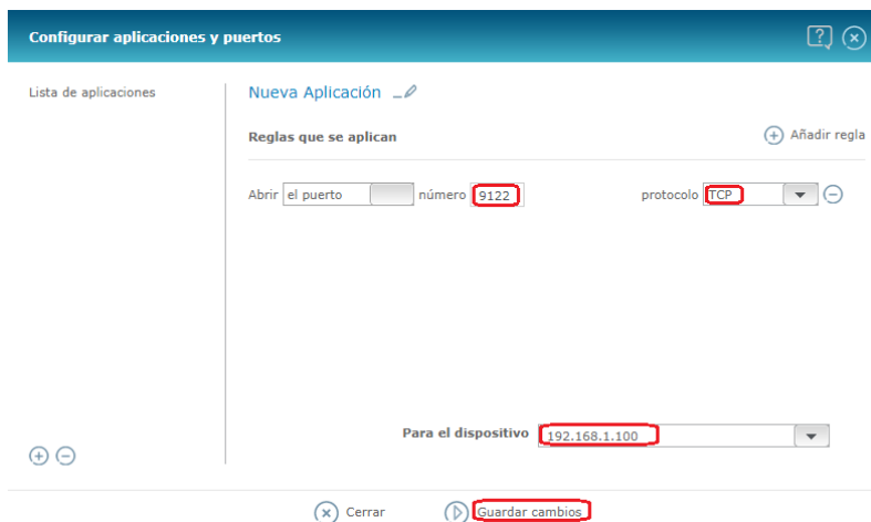
Figura 66: Apertura del puerto 9122 en el router ZTE H108N
