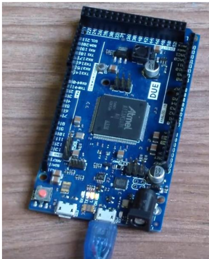
Figura 76: Conexión del Arduino DUE al puerto USB Programming
