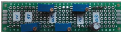
Figura 6: Placa acondicionadora transformador
