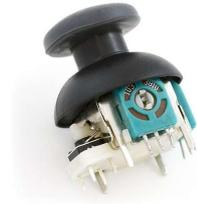
Arduino mediante la función `AnalogRead()` lee el recorrido del joystick en cada uno de los ejes, usando además la función `map()` podremos cambiar la escala del valor leído permitiendo un control progresivo. El joystick al moverse crea una diferencia de tensión que es regulada por el potenciómetro, creando una lectura digital de la posición movida por el mismo.
