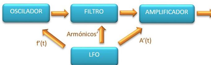
Figura 2-4. Encadenamiento de los elementos del sintetizador y posibles interacciones con el LFO.
