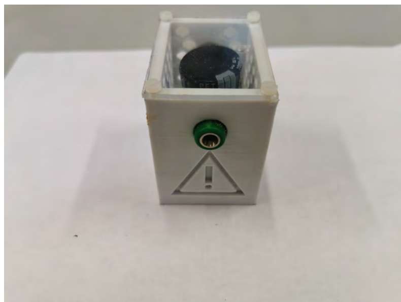
Figura 6-22 Bloque de condensador finalizado, vista lateral
