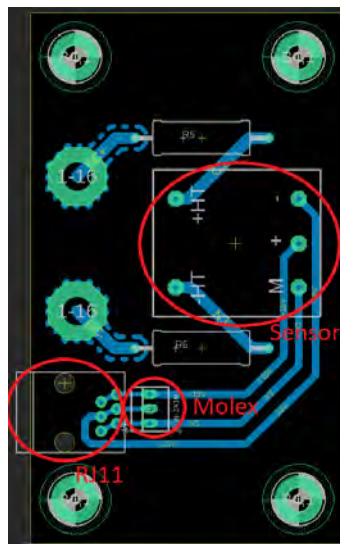
Figura 4-13 Principales elementos señalados del sensor de voltaje
