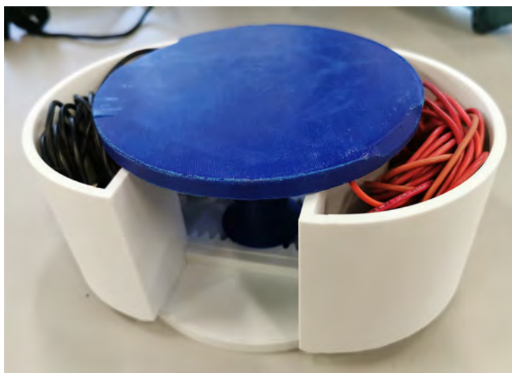
Figura 6-37 Caja para el almacenamiento de los cables abierta
