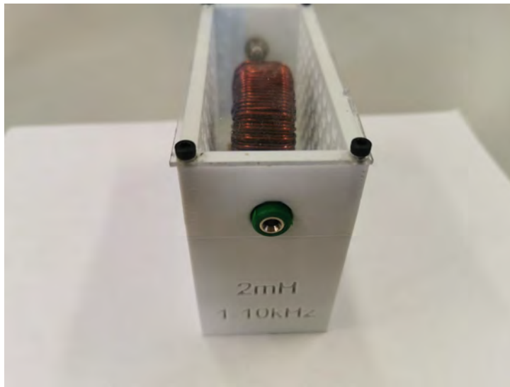
Figura 6-19. Bloque de bobina terminado, vista lateral
