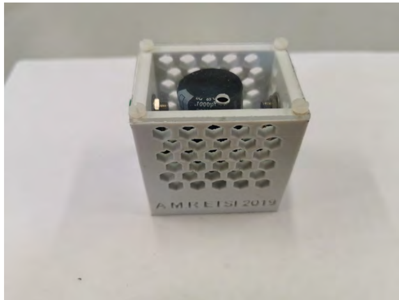
Figura 6-21 Bloque de condensador finalizado, vista frontal
