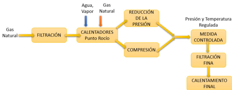
Figura 21: Esquema funcionamiento de una ERM.
