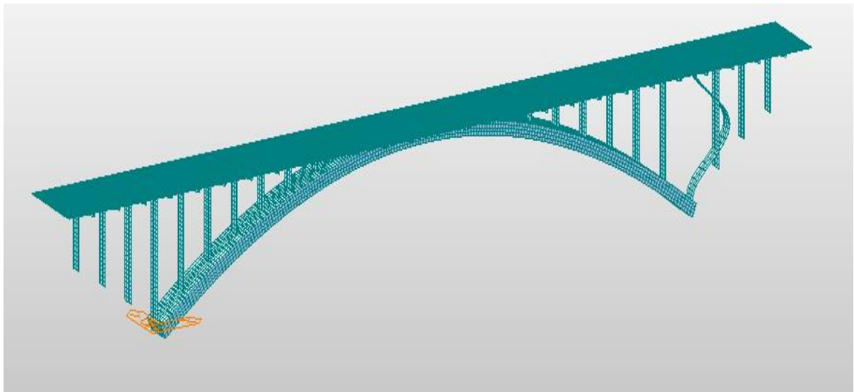
Imagen 84 Primer modo de pandeo del modelo de arco rígido.
