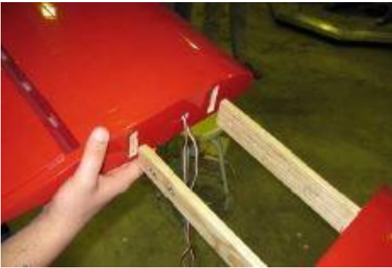
Ilustración 2-5. Ejemplo machihembrado Céfiro [29]
