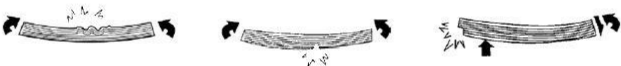
Ilustración 2-13. De izquierda a derecha: rotura a compresión, tracción y delaminación. [8]
