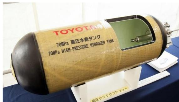
Figura 6-7. Tanque tipo IV [34]
