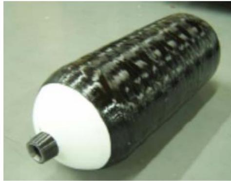
Figura 6-5. Tanque tipo II [32]
