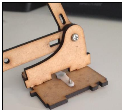
Figura 3-19. Unión del soporte con el eslabón de la base.
