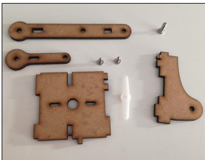
Figura 3-14. Elementos centrales del robot y soporte del brazo
