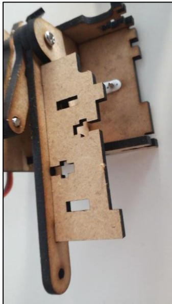
Figura 3-24. Elementos de la parte derecha con el eslabón de la base
