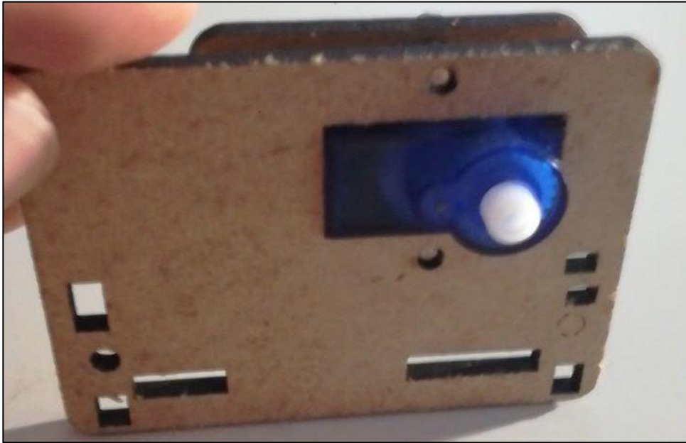
Figura 3-8. Servomotor para la articulación del codo
